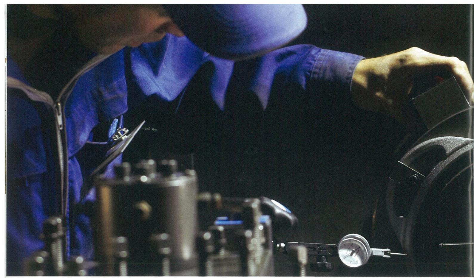
バーミキュラの命ともいえる蓋と本体の密閉性を高めるため、測定しては削る作業を繰り返し、0.01mm以下の精度まで削り込む。まさに職人技だ。
